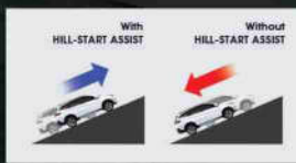
Hill-Start Assist (HSA) (R All) Ketika berhenti di tanjakan mobil akan terlanjur beberapa saat sehingga tidak mundur pada saat berakselerasi.
